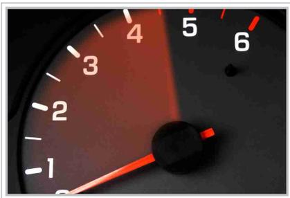
**3** Para los cambios de marchas según las revoluciones en los **motores de gasolina realizarlos en torno a las 2.000 rpm**. En los motores diésel en torno a las 1.500 rpm. Según la velocidad poner 3ª a partir de unos 30 km/h, 4ª a partir de unos 40 km/h y 5ª a partir de unos 50 km/h. En ciudad, siempre que sea posible, utilizar la 4ª y la 5ª, respetando siempre los límites de velocidad.
