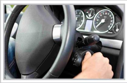
**1** Arrancar el motor **sin pisar el acelerador**, luego iniciar la marcha inmediatamente después del arranque. Sin embargo, en los motores con turbo, esperar unos segundos antes de comenzar la marcha. En **paradas prolongadas, de más de un par de minutos**, es recomendable **apagar el motor** si las condiciones lo permiten.
